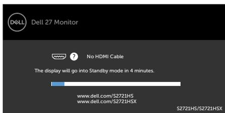
4. Esta caixa também é exibida durante o funcionamento normal do sistema, se o cabo de vídeo se desligar ou estiver danificado.
