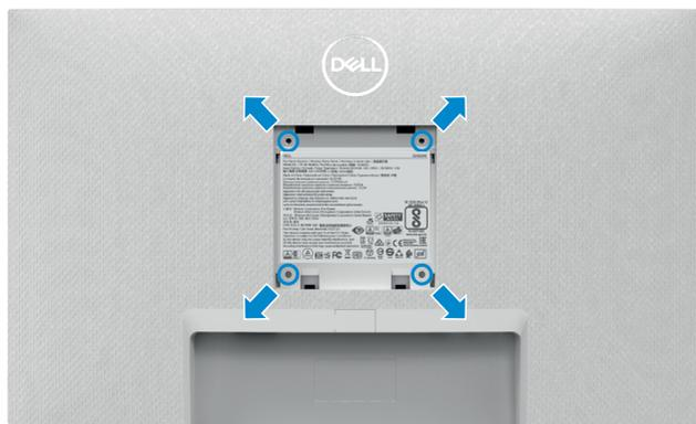
**NOTA:** Utilize parafusos M4 de 10 mm para fixar o kit de montagem em parede ao monitor.
